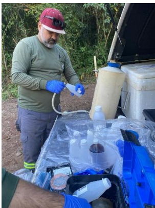
g. Enchimento dos frascos a partir da garrafa de Van Dorn
